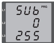
Fig. Subnet mask (SUB), Byte 0, value 255
